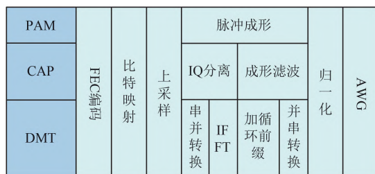
图1 三种调制格式的发送端DSP流程
