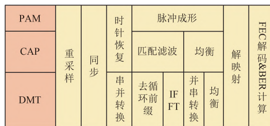
图2 三种调制格式的接收端DSP流程
