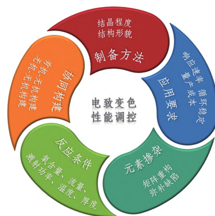
图2 氧化钨薄膜的 EC 性能调控策略示意图
