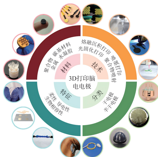
图 1 3D 打印 EEG 电极技术、材料、特性及电极分类示意图
