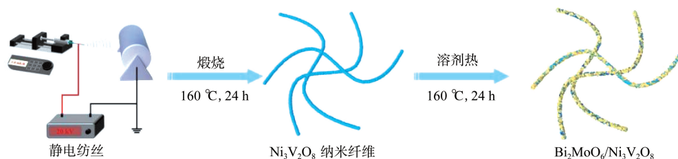
图1 Bi 2 MoO 6 /Ni 3 V 2 O 8 纳米纤维的制备流程图
