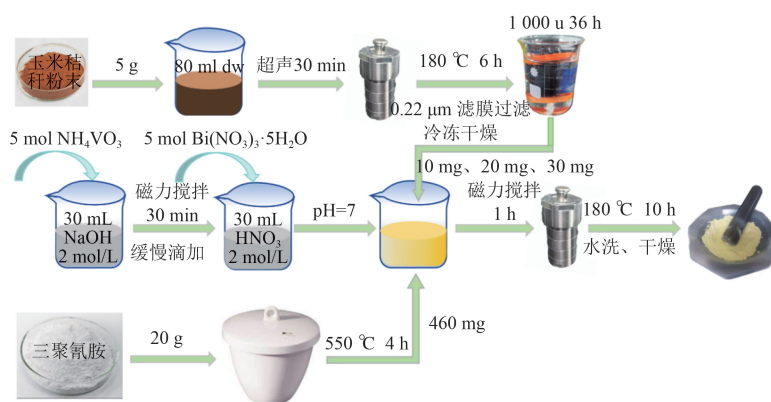
图 1 玉米秸秆基 CQDs/CN/BiVO 4 复合材料制备流程
