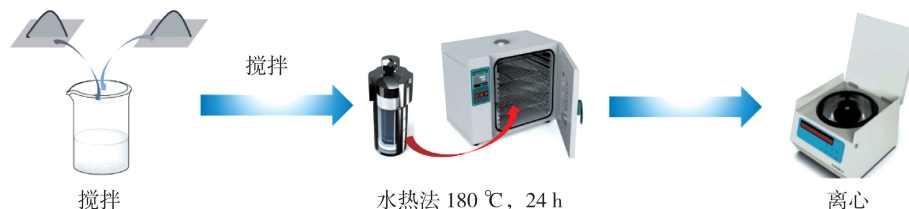
图1 \text{MoS}_2@\text{Fe}_3\text{O}_4 的制备工艺路线图
