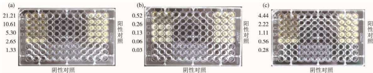
图6 CTAB 包被的球形纳米金(a)、棒状纳米金(b)、三角形纳米金(c)对金黄色葡萄球菌37℃下培育24 h得到的最小抑菌浓度图(图中数字为纳米金的浓度, 单位为 µg/mL)
