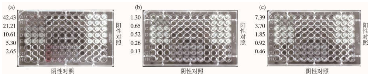
图7 CTAB 包被的球形纳米金(a)、棒状纳米金(b)、三角形纳米金(c)对大肠杆菌37℃培育24 h得到的最小抑菌浓度图(图中数字为纳米金的浓度, 单位为 µg/mL)
