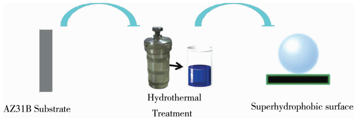
图 1 AZ31B 镁合金超疏水表面制备过程示意图
