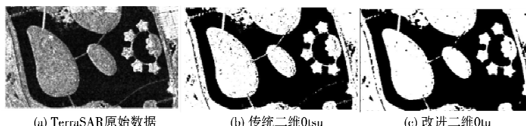
图 5 TerraSAR-X 数据使用二维 Otsu 检测水域 [19]
